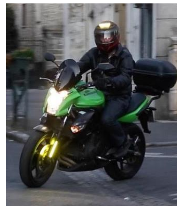
La solution idéale : un phare central blanc pour bien éclairer la route et l'ajout de feux de jour jaunes sur le casque et la fourche. L'idée est d'augmenter l'envergure lumineuse des motos et de les différencier nettement (de jour comme de nuit) dans le trafic routier.
