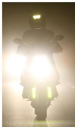
La solution idéale : un phare central blanc pour bien éclairer la route et l'ajout de feux de jour jaunes sur le casque et la fourche. L'idée est d'augmenter l'envergure lumineuse des motos et de les différencier nettement (de jour comme de nuit) dans le trafic routier.
